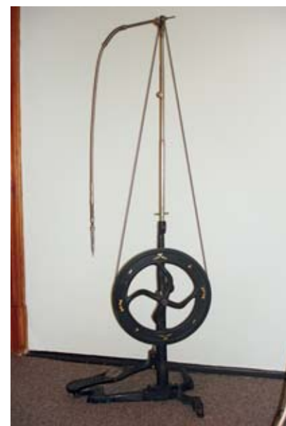
Abbildung 1 Von Morrison 1871 aus einem Spinnrad entwickelte Tretbohrmaschine.
